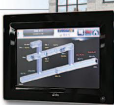
À la tête du système se trouve un écran tactile assurant le contrôle de la température, de l'humidité et de la ventilation. Il envoie des commandes sans fil aux trois unités de ventilation situées sur le toit, qui agissent alors en conséquence, actionnant les compresseurs, les ventilateurs ou l'humidificateur.
